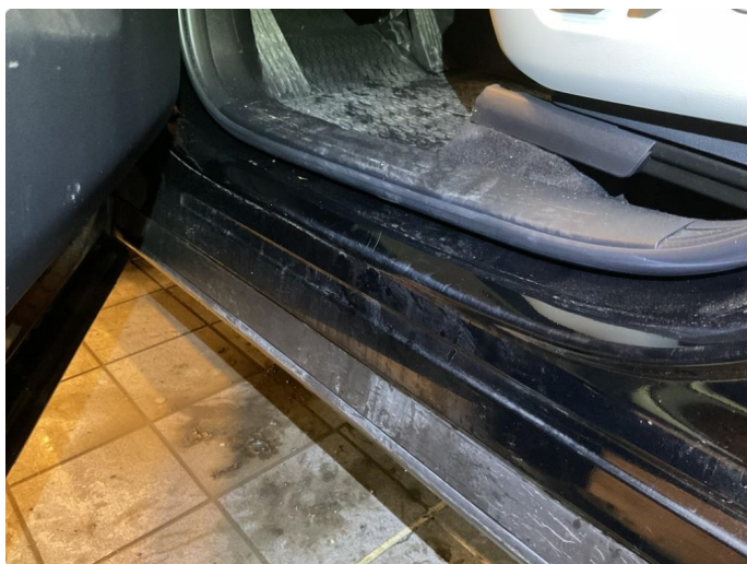
1.4 Noe slitasje innsteg begge sider foran. Fremstår som normalt
