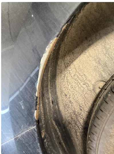
1.1 Lakk flasser- Utbedret!
