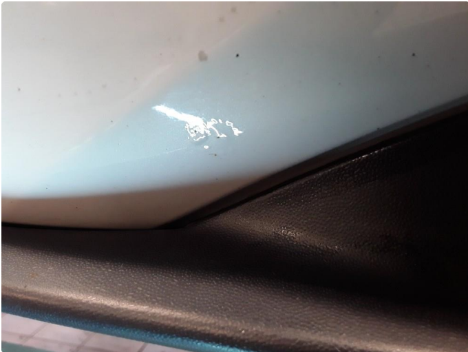
1.2 Liten steinsprut med korrosjon.
