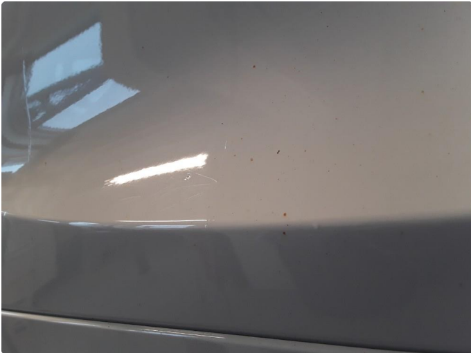
1.2 Liten steinsprut med korrosjon venstre fordør.
