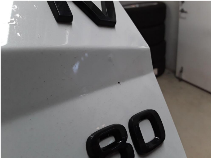
1.4 Liten steinsprut med korrosjon.
