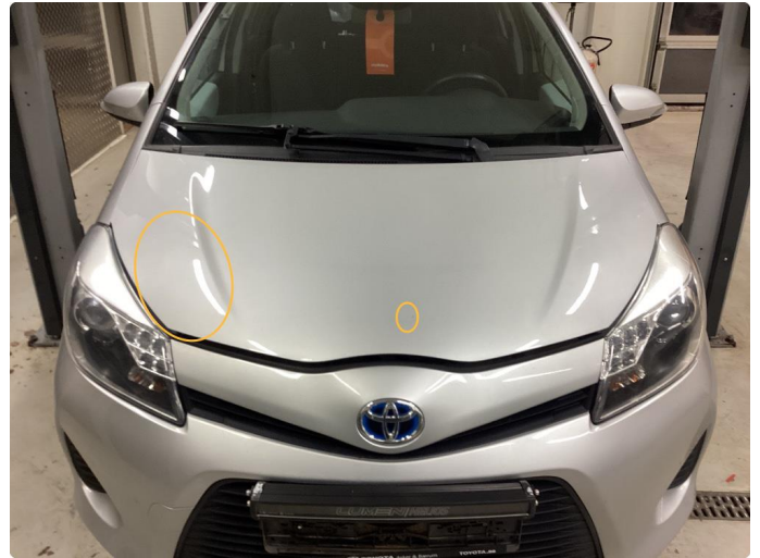
1.1 Noe steinsprut med rust
