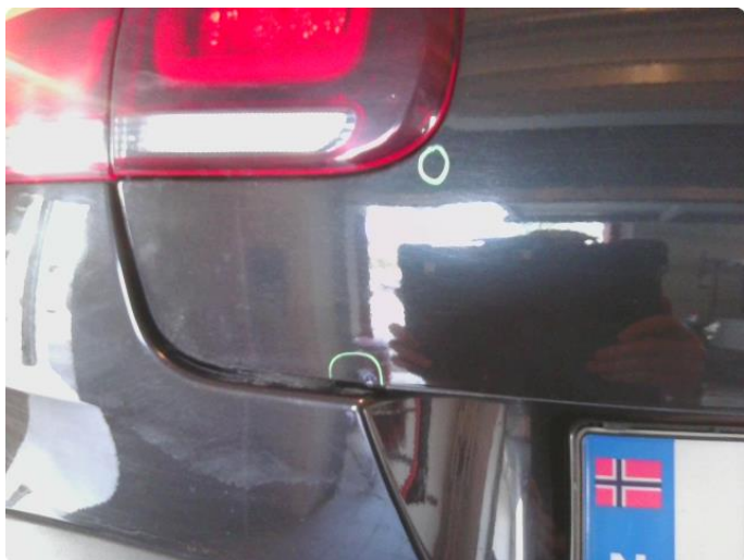
2.7 Steinsprut med rust
