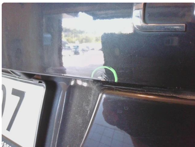
2.7 Steinsprut med rust
