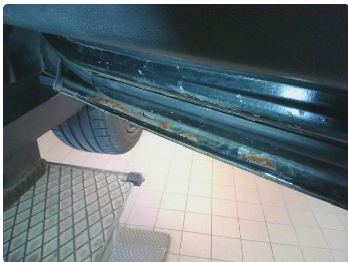
2.6 Rust i fals
