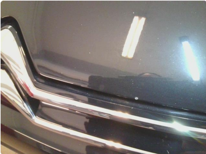
2.2 Noe steinsprut med rust
