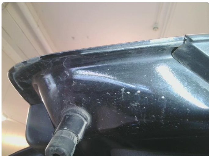
2.7 Steinsprut med rust
