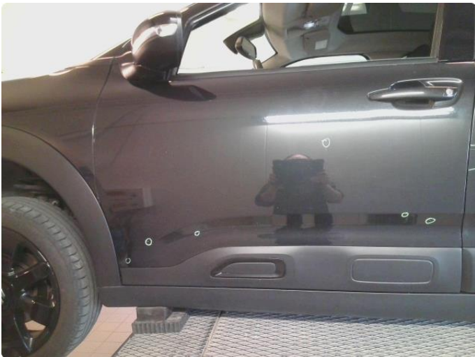
2.3 Steinsprut med rust
