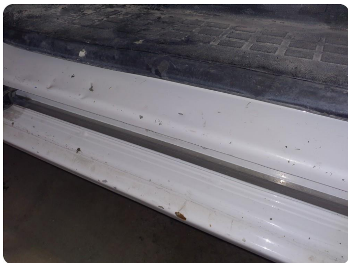
3.6 Noen riper og småbulker Mye riper og småbulker. Tillegg rust
