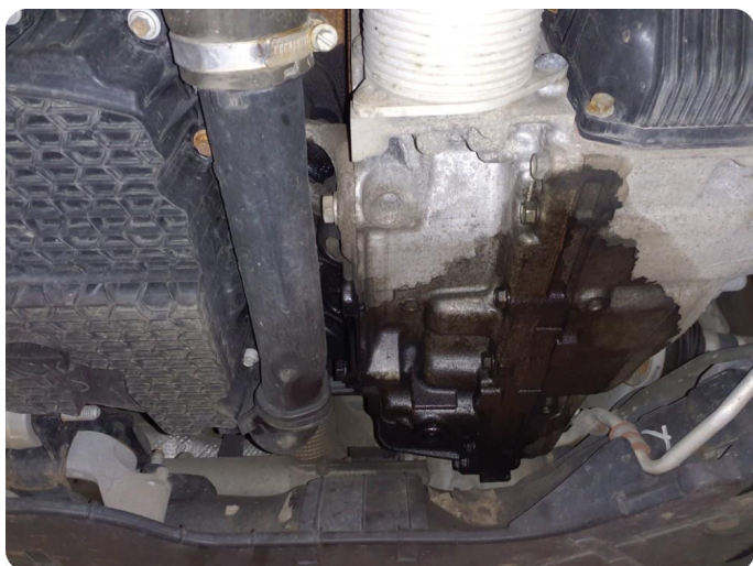
4.2 Oljelekkasje mellom motor/gear Må kontrolleres
