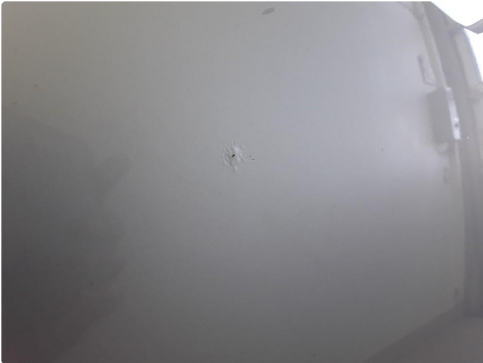
1.2 Liten steinsprut med korrosjon venstre skyvedør.
