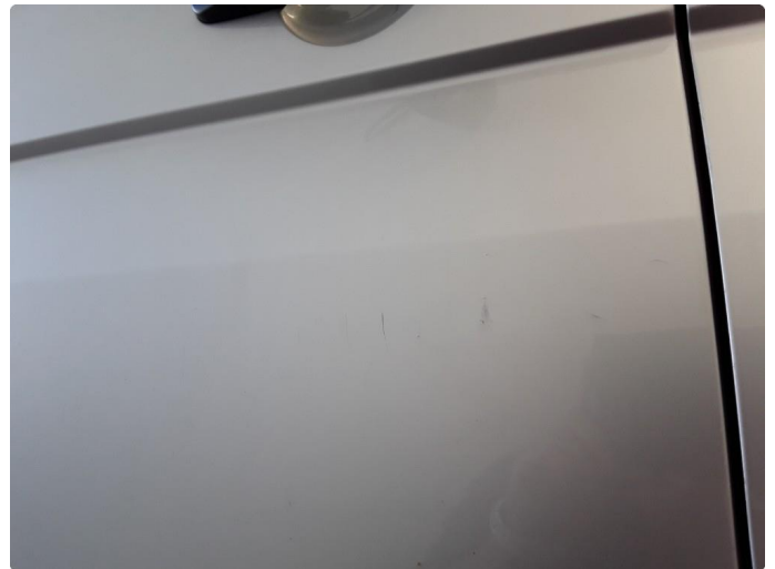
1.3 Liten steinsprut med korrosjon høyre skyvedør.
