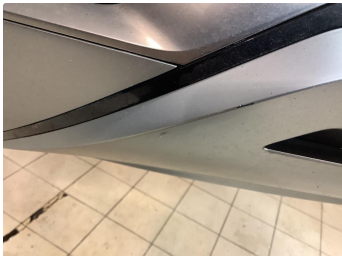
1.2 Ripe(r) ned til grunning
