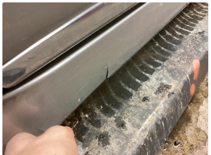
1.5 Liten sprekk i deksel under
