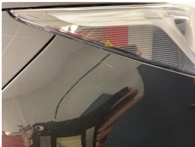
1.3 Ripe(r) ned til grunning
