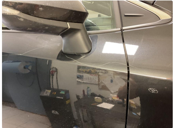
1.1 Ripe ned til grunning
