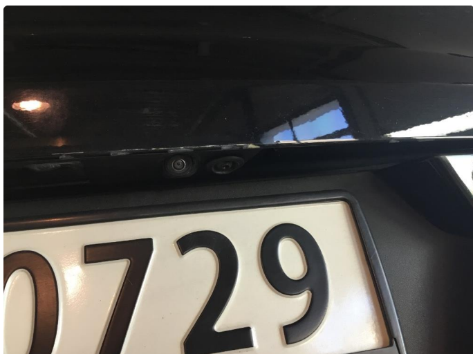
1.1 Ripe(r) ned til grunning
