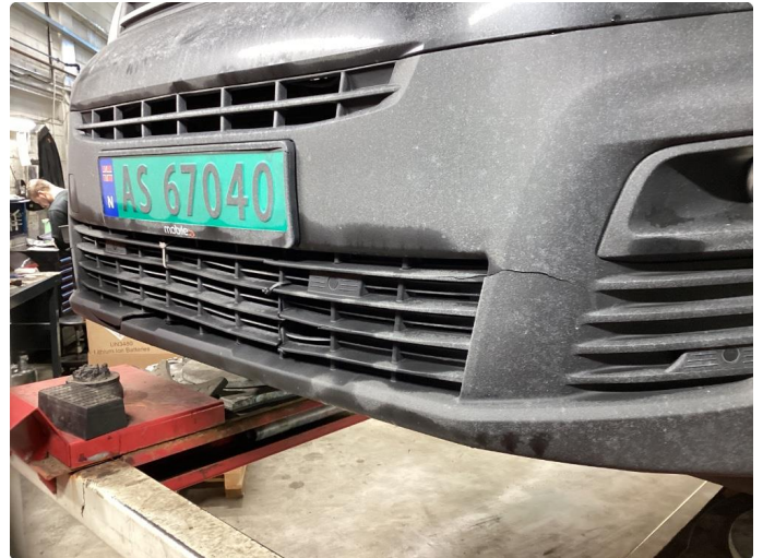
1.2 Sprukket- Blir reparert før salg
