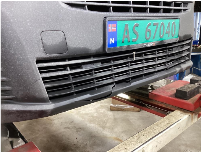
1.2 Sprukket- Blir reparert før salg
