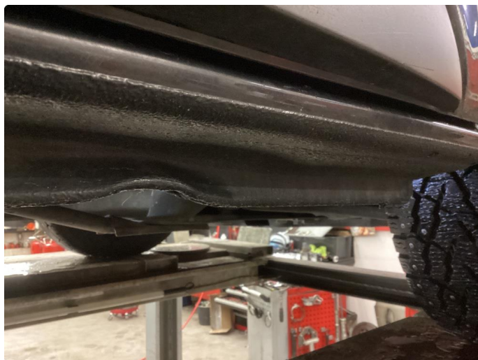
1.8 Liten skade på jekkkfeste
