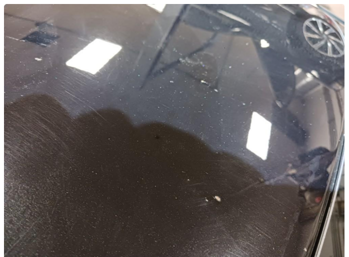
1.7 Steinsprut med rust
