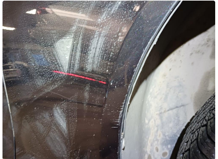
1.2 Ripe(r) ned til grunning
