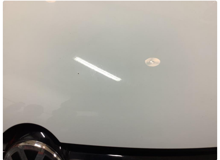
1.1 Noe steinsprut med rust
