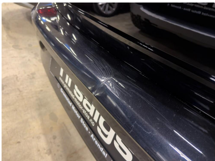
1.1 Liten bulk med sprekk i lakk
