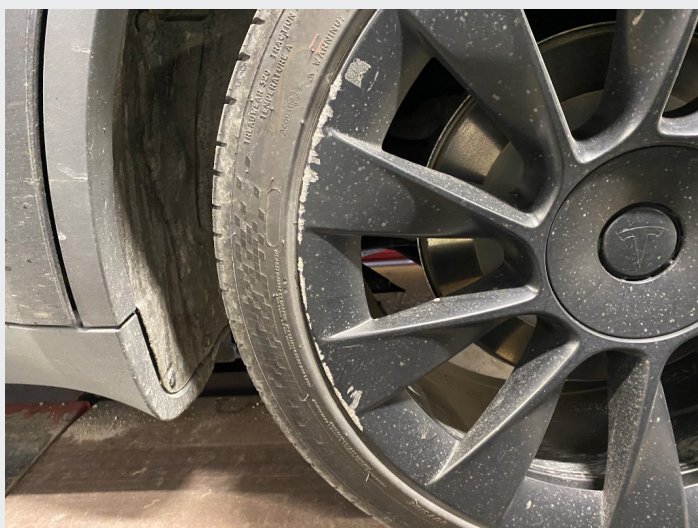
2.18 alle 4 felger er kantkjørt, dekk høyre bak har rift i siden
