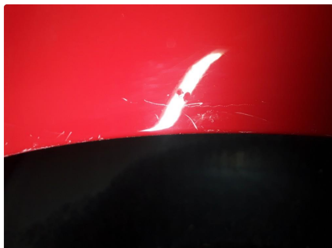
1.3 Liten steinsprut med korrosjon.
