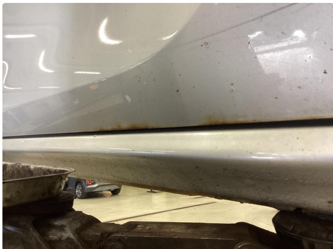
1.1 Rust i fals
