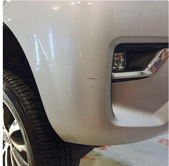
1.1 Riper. VURDERES TIL NORMAL BRUKSSLITASJE.
