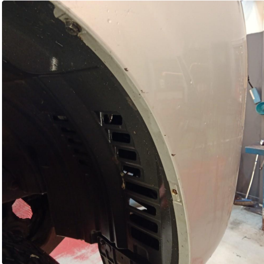
1.1 Riper. VURDERES TIL NORMAL BRUKSSLITASJE.
