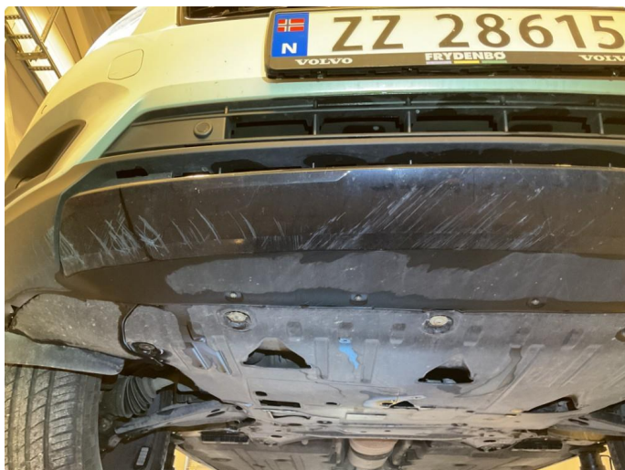
1.5 Skrubbskade under støtfanger foran. Fremstår ikke sjenerende
