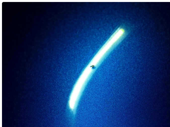
1.3 Liten steinsprut med korrosjon.
