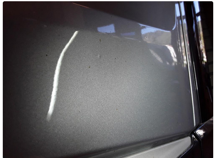
1.4 Liten steinsprut med korrosjon høyre fordør.
