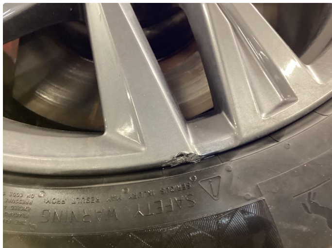
1.3 Skade på felg
