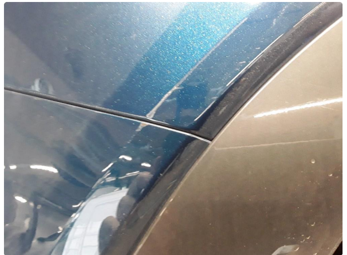
1.2 Ripe(r) ned til grunning
