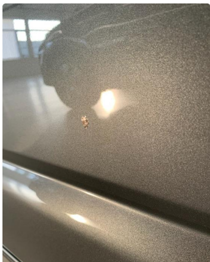
1.1 Div. steinsprut med korrosjon, småbulker og riper.
