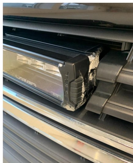
2.1 Ekstralys noe korrodert .
