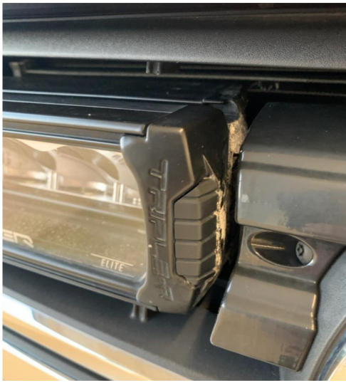
2.1 Ekstralys noe korrodert .
