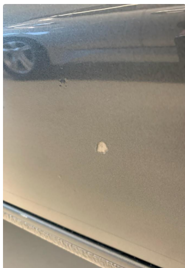
1.1 Div. steinsprut med korrosjon, småbulker og riper.
