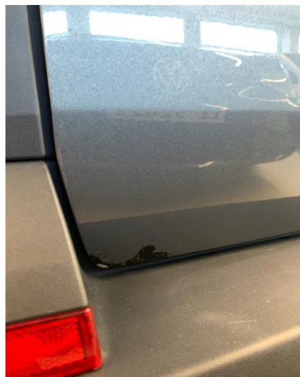
1.1 Div. steinsprut med korrosjon, småbulker og riper.
