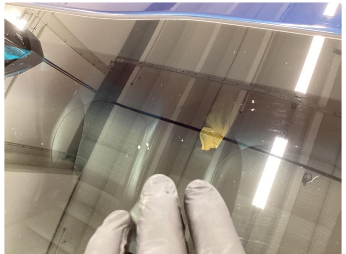
1.2 Slitt frontrute, mange Steinsprang og slitasje fra gammelt Pusserblad
