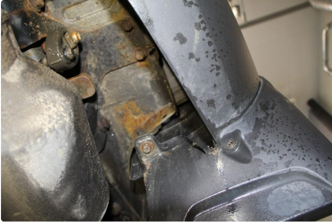
1.2 Litt rust i chassis bak.
