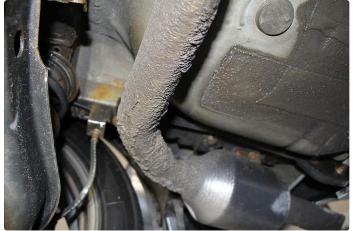
1.2 Litt rust i chassis bak.
