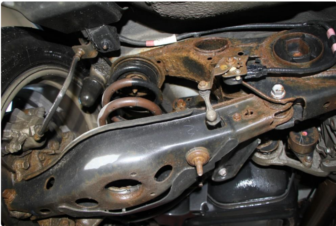
1.2 Litt rust i chassis bak.
