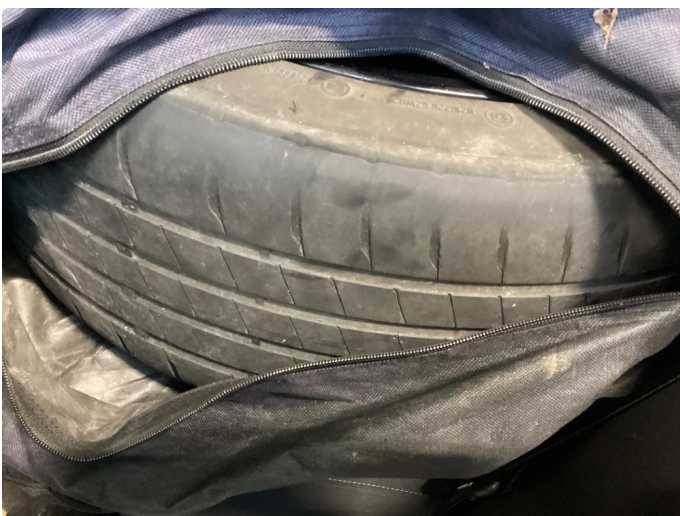
1.3 Skjev slitasje på vinterdekk
