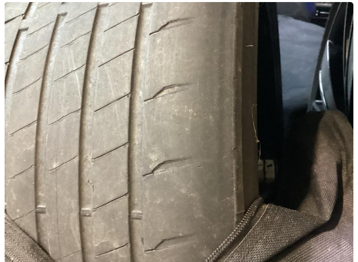
1.3 Skjev slitasje på vinterdekk
