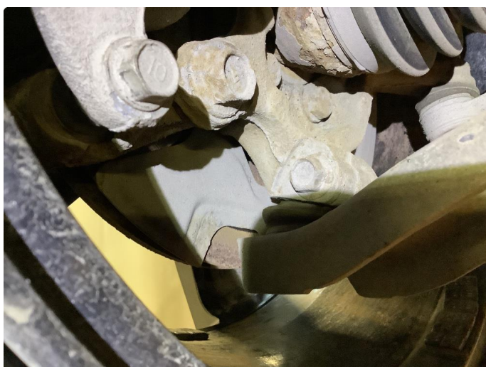
2.1 Rust bremseskiver foran innvendig på begge siden, blir reparert før salg.
