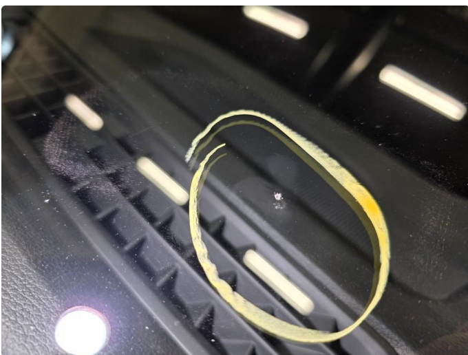
1.7 Steinsprut med sprek
