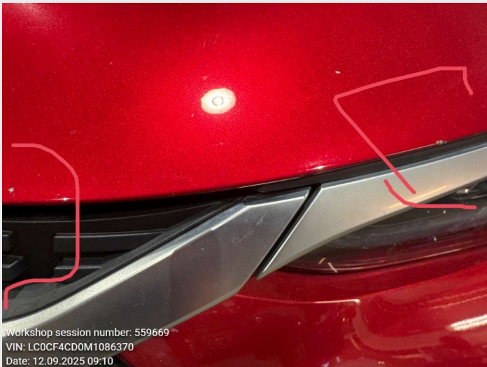
2.3 Mye steinsprut på panser
