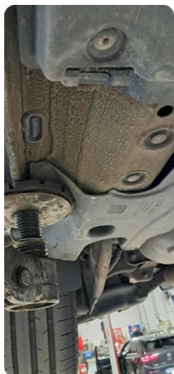
1.1 Beskyttelsesplate skadet/mangler. Bakre deksel under bil, h.side, defekt
