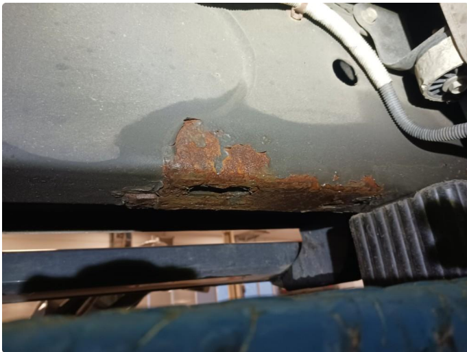
1.1 Noe overfalte rust i ramme
