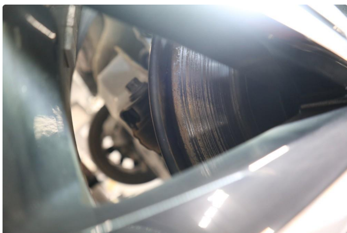
2.1 Noe rust,slites vekk ved kjøring
