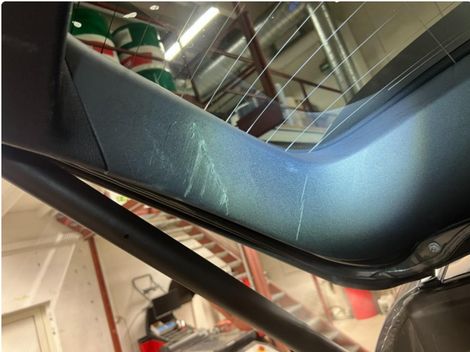
3.1 Noen riper innside av bagasjerom
