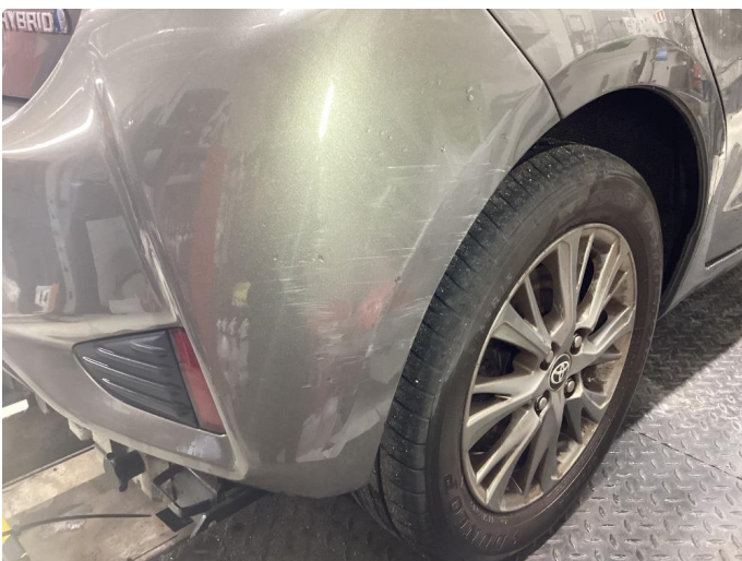
1.2 Ripe(r). UTBEDRINGER UTFØRT PÅ KLARGJØRINGEN + LAKKSTIFT BENYTTET.
