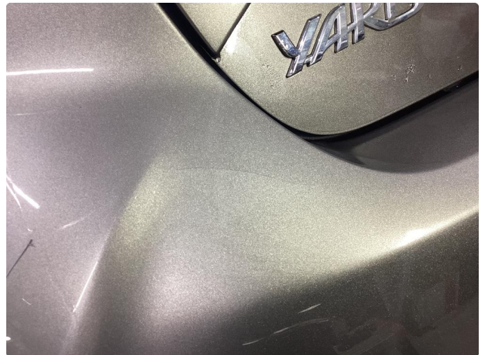
1.2 Ripe(r). UTBEDRINGER UTFØRT PÅ KLARGJØRINGEN + LAKKSTIFT BENYTTET.
