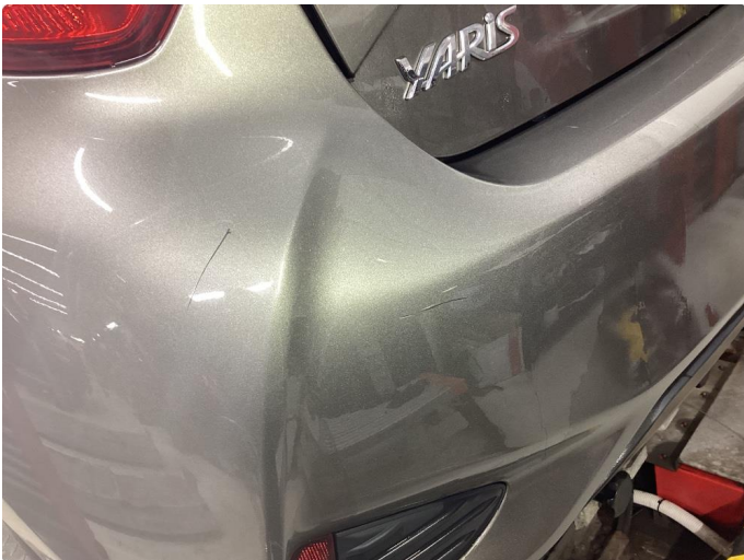
1.2 Ripe(r). UTBEDRINGER UTFØRT PÅ KLARGJØRINGEN + LAKKSTIFT BENYTTET.
