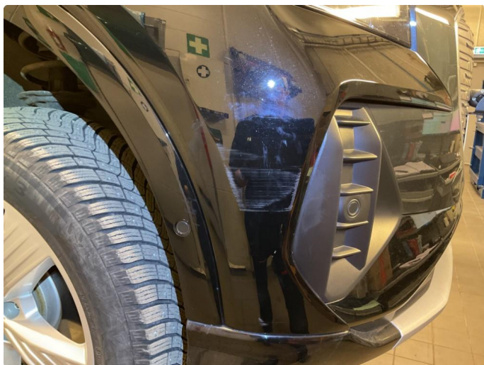
1.3 Noe små steinsprut frontfanger
