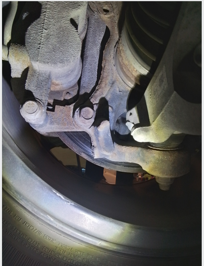
9.7 Bremsebelegg på yttersiden skiver har falt av
