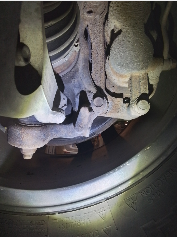
9.7 Bremsebelegg på yttersiden skiver har falt av
