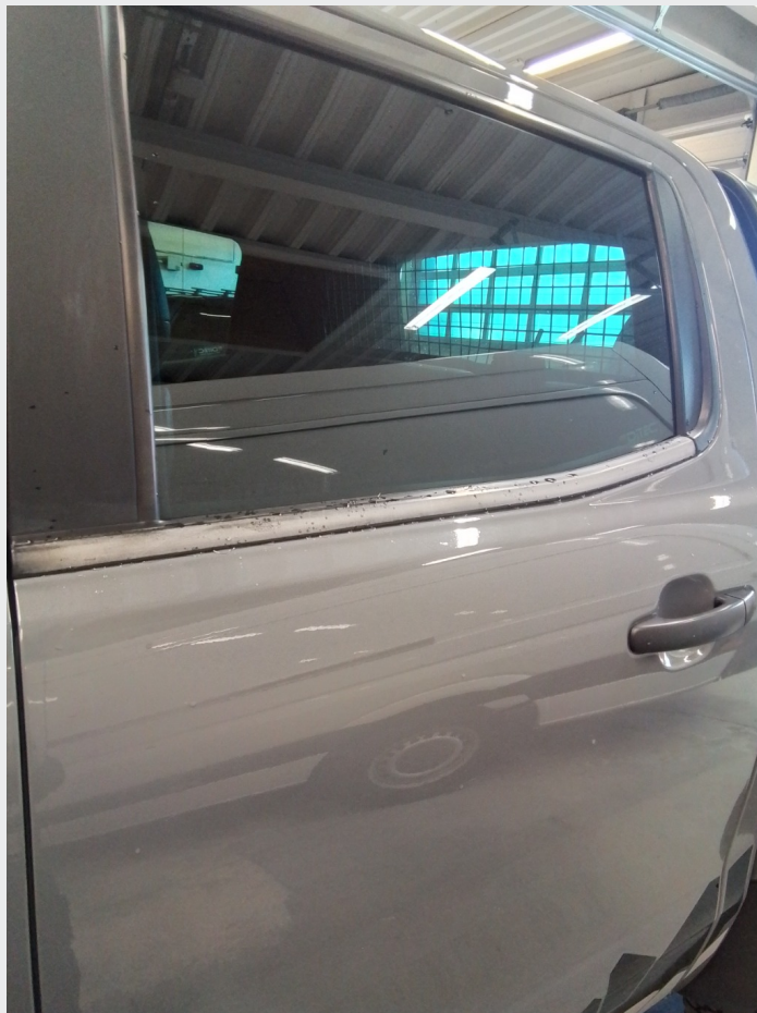
2.5 Lister dører venstre side misfarget
