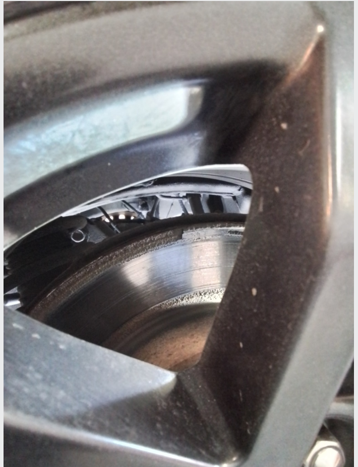
9.7 Btemsebelegg på ytterkant (utside) og innerkant (innside) skiver bak har falt av
