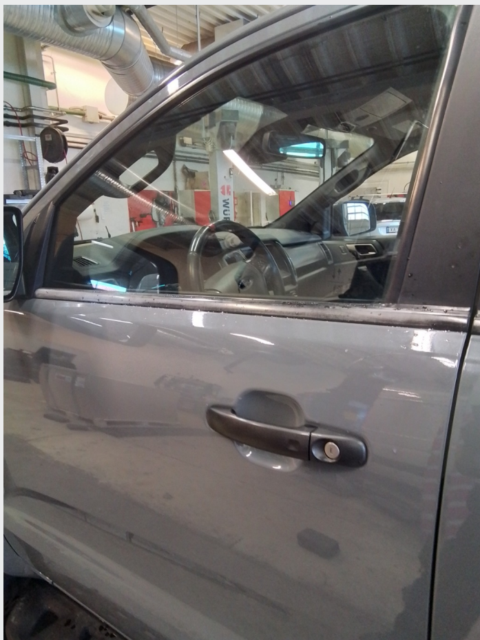
2.5 Lister dører venstre side misfarget
