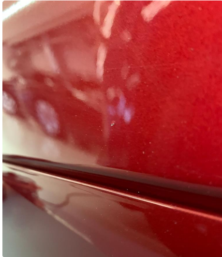
1.1 Liten steinsprut med korrosjon venstre fordør.
