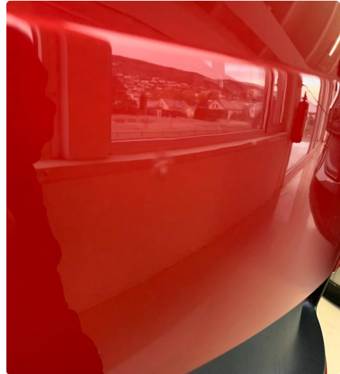
1.2 Liten steinsprut med korrosjon.
