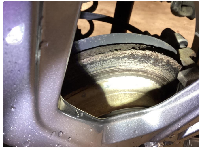
2.1 Mer enn 25% rust- Skiver og klosser bak blir skiftet uke 44
