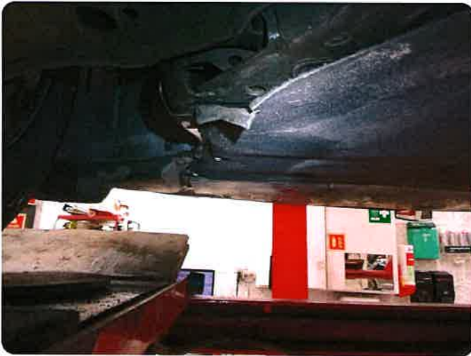
1.1 Beskyttelsesplate skadet/mangler Under motor og girkasse
