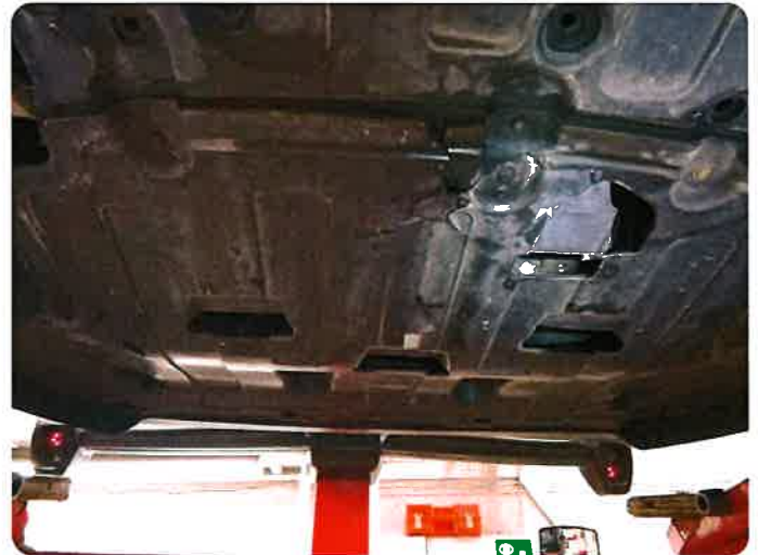
1.1 Beskyttelsesplate skadet/mangler 2stk plater under motor og girkasse sprukket
