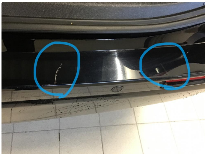
1.1 Ripe(r) ned til grunning
