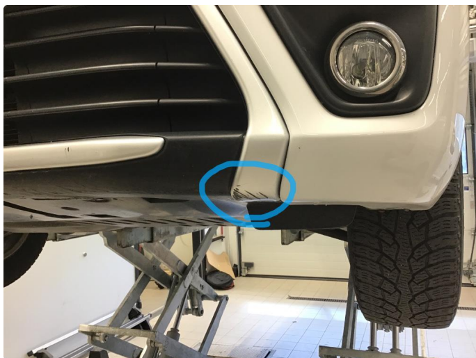
1.6 Ripe(r) ned til grunning
