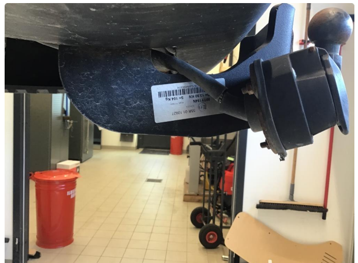
1.4 Tilhengerkontakt- innfesting skadet
