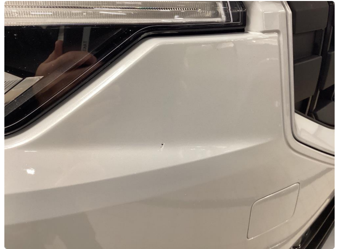
1.3 Steinsprut, normal slitasje med tanke på alder og km
