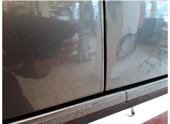
1.3 Steinsprut med korrosjon høyre skyvedør.
