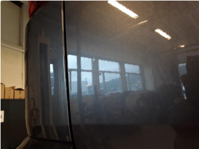
1.4 Steinsprut med korrosjon.
