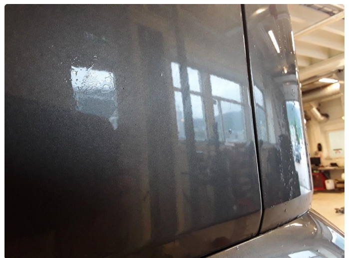
1.6 Steinsprut med korrosjon venstre bakskjerm.
