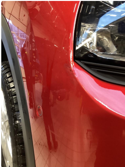
1.3 Ripe(r) ned til grunning
